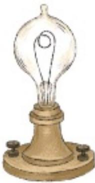
А в 1880 году американец Томас Эдисон придумал заменить стержни нитью накаливания из обычной швейной нитки, покрытой угольной пылью, запаять её в стеклянный шар, откачать оттуда воздух ипустить по ней ток. Лампа Эдисона давала яркий свет уже в течение 40 часов!
